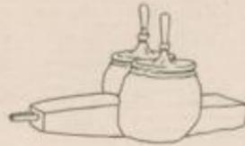
Einpaariges Holzschalengebläse ohne Trennschnitt und mit kurzen Triebstäben
