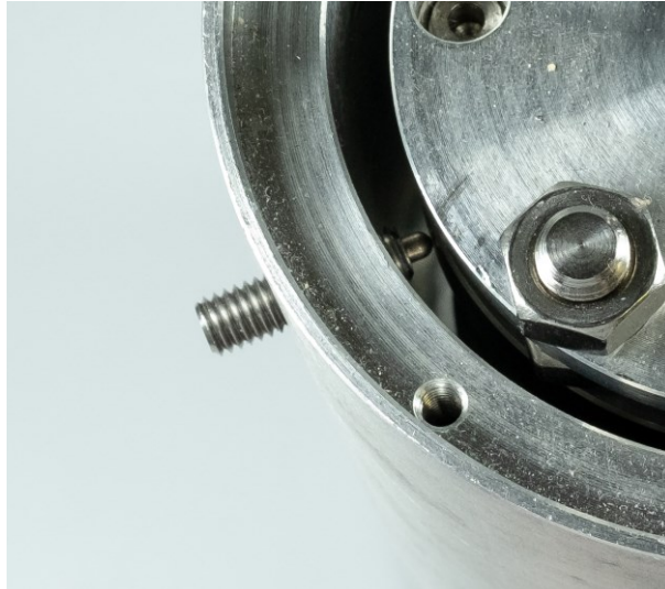
Abb. 28: Stellschraube und Gerüstzylinderwand
