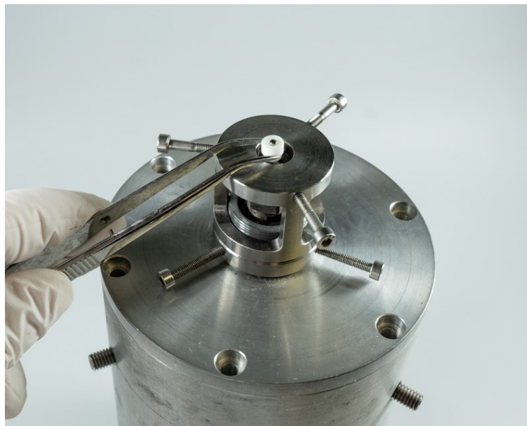
Abb. 47: Einsetzen der Schraubenkopfauflage
