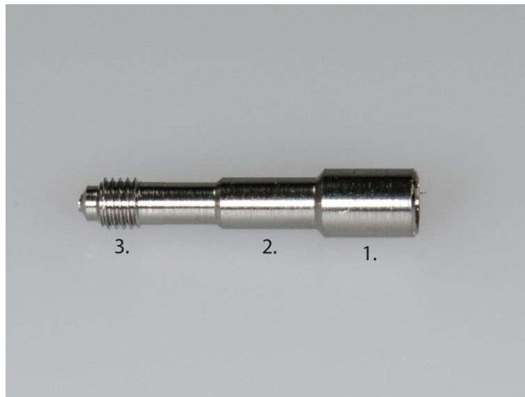
Abb. 11: Im Versuch verwendete Abutmentschraube (Übersicht)
