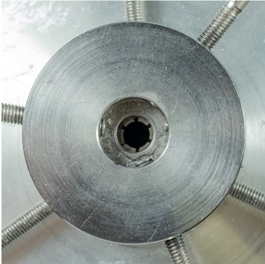
Abb. 30: Spannfutter in zentraler Ausrichtung unter der Schraubenkopfaufnahmehalterung
