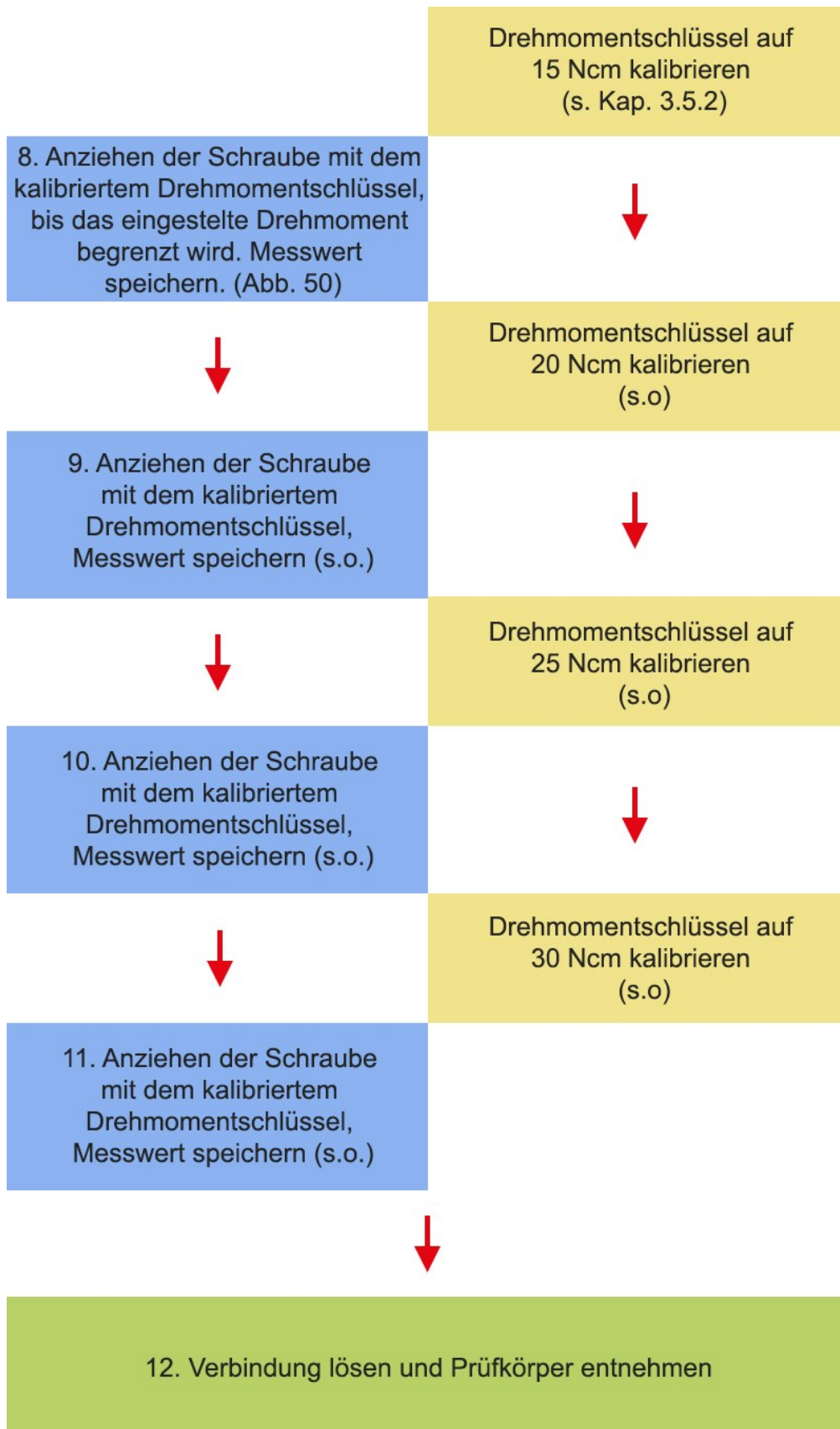
Abb. 51: Flussdiagramm Versuchsdurchführung
