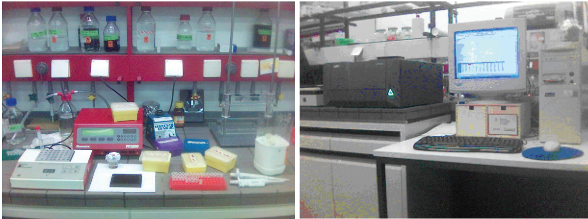
Abbildung 9: Fotos des Arbeitsplatzes für die Durchführung des Tat-TAR-FRET-Assay; Links der Platz an dem die Pipettierung der Lösungen auf die Mikrotiterplatte erfolgte. Rechts das Spektrometer mit dem Steuerungscomputer. Die beiden Arbeitsplätze befinden sich direkt gegenüberliegend im Labor.
