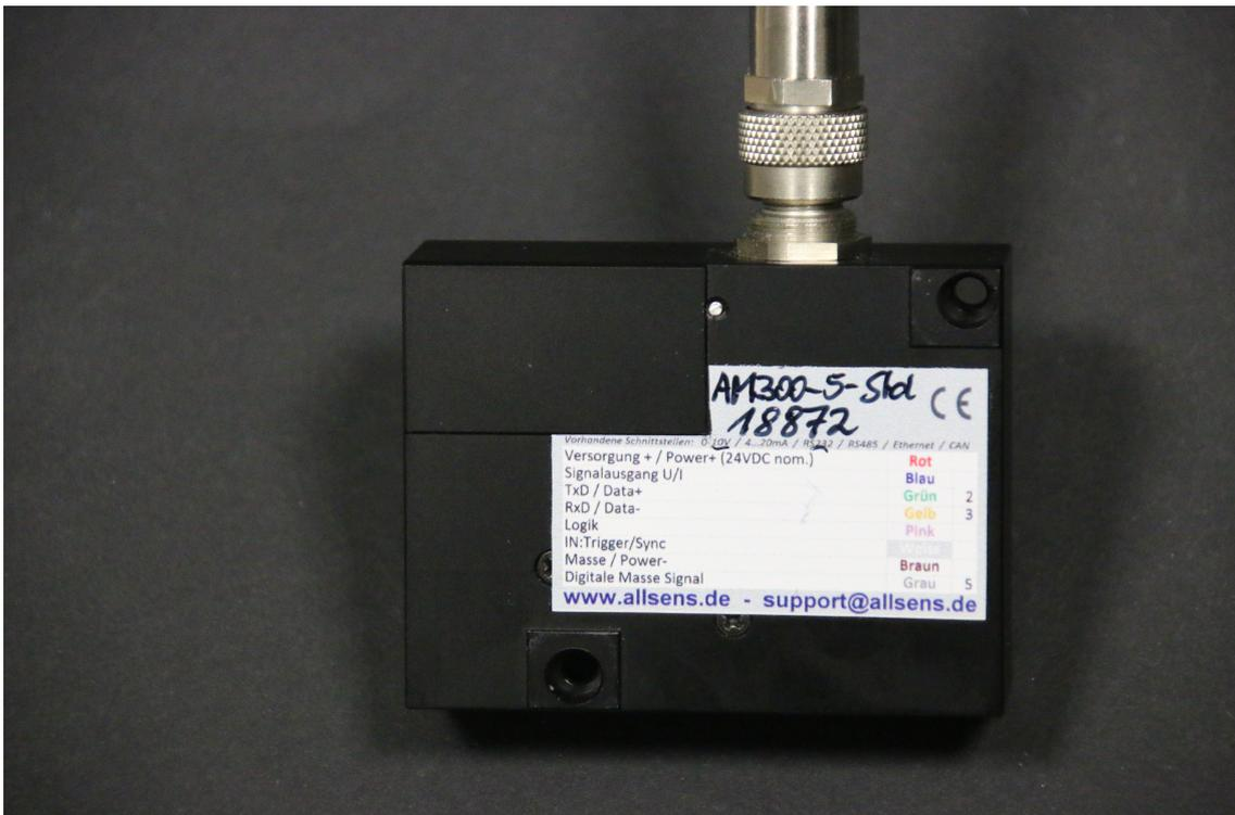
Abbildung 28: Laserwegsensor
