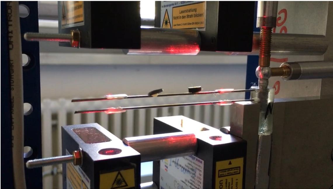
Abbildung 29: eingespannter Prüfkörper im Kausimulator
