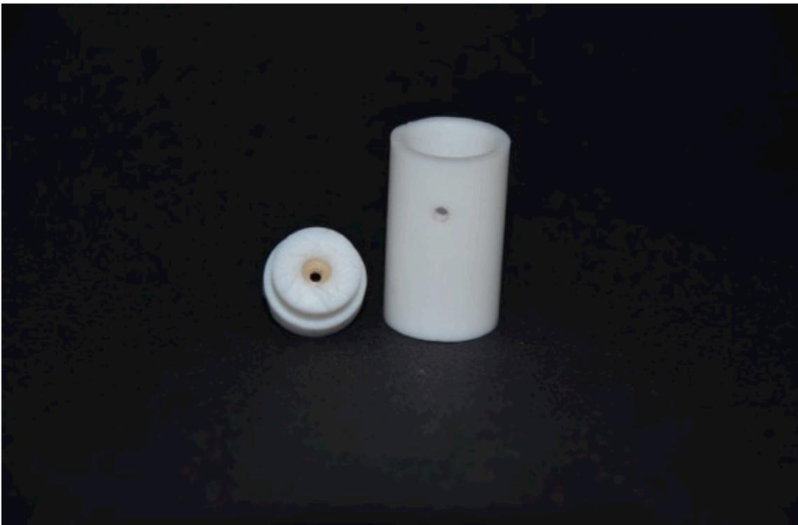
Abbildung 7: Einbettzylinder und Implantalthalterung demontiert für Simulation von Knochenaufbau
