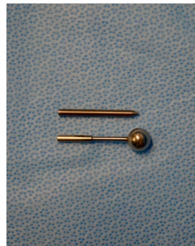
Abbildung 5: Die Stifte. Das Zentrum der Kugel und die Spitze der konischen Stifte sind auf gleicher Höhe, weshalb die Stifte während des Experiments austauschbar sind. (Eigene Darstellung)
