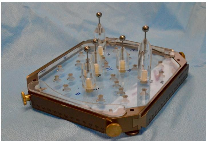
Abbildung 4: Das Phantom, eingespannt in den Leksell® Rahmen, mit den kugelförmigen Metallstiften. (Eigene Darstellung)
