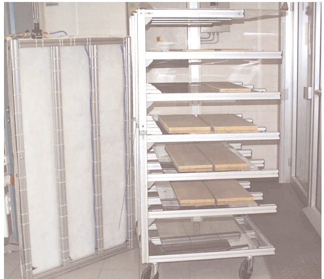
Belüfteter Hordenwagen zur Trocknung von wasserlackbeschichteten Flachteilen mittels strömender Luft
