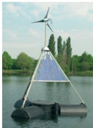
Abb. 1: NESSIE – Energieautarke Phosphoreliminationsanlage im Waidsee in Weinheim.
