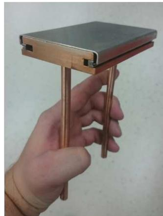
**Abbildung 4.7:** Tuningplatte des MYRRHA-RFQs mit Silberplatte zur besseren elektrischen Kontaktierung zur Stütze.
