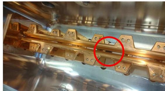
**Abbildung 4.30:** Messung der Frequenzverstimung des RFQs mit einem Störkörper (jeweils in der roten Markierung).
