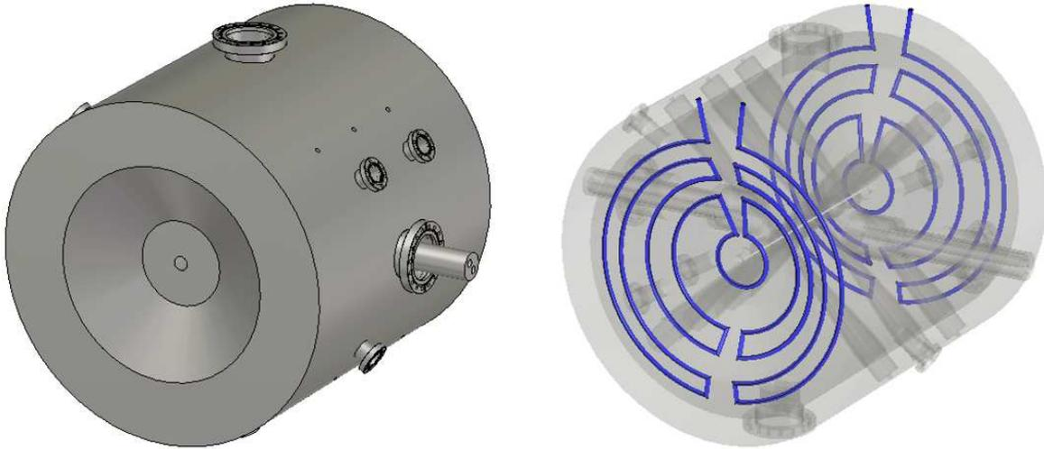
**Abbildung 5.19:** Abbildung des MYRRHA-CH5-Simulationsmodells (links) und den neuen Kühlkanälen in den Deckeln (rechts).
