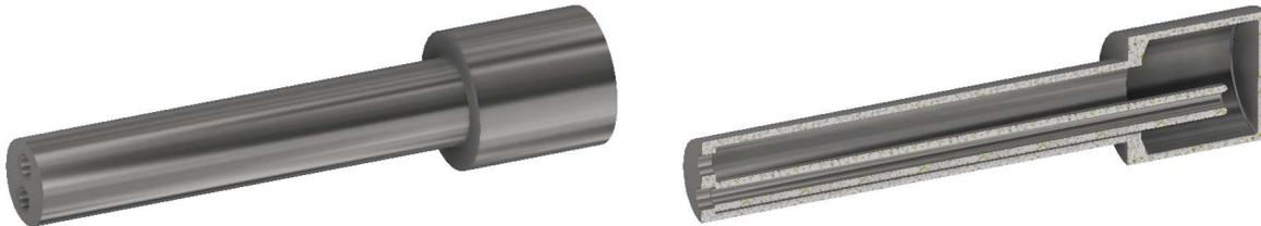
**Abbildung 5.25:** .stp-Modell eines Tauchkolbens (links) und Schnittansicht mit Blick auf dessen innenliegende Kühlwasserzuleitung (rechts).
