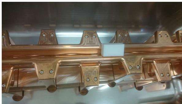
**Abbildung 4.19:** Teflonklötzchen zwischen den oberen Elektroden während einer Flatnessmessung.
