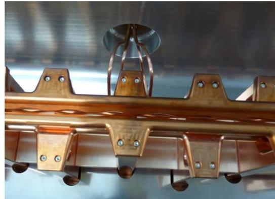
**Abbildung 4.22:** Montierte Einkoppelschleife im MYRRHA-RFQ.
