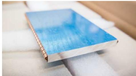
**Abbildung 4.18:** Dummytuningplatte, die zum Einstellen der Frequenz und der Flatness verwendet wird.
