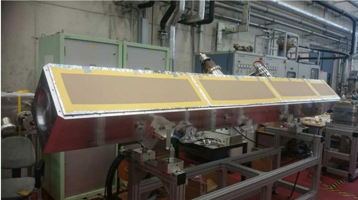
**Abbildung 4.32:** MYRRHA-RFQ in der Experimentierhalle des IAP mit provisorischem Deckel während der Dipolmessungen.
