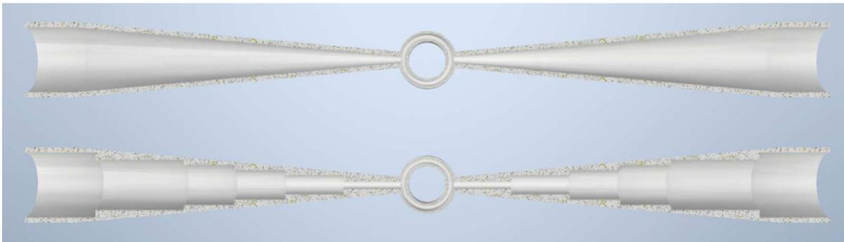
**Abbildung 5.20:** Vergleich der konischen Kühlung (oben) mit der schrittweise kleiner werdenden Kühlung einer CH-Stütze.
