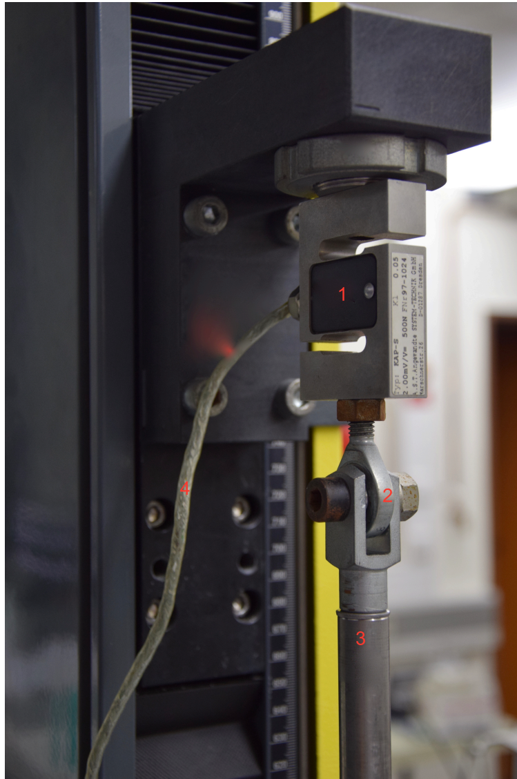
Abbildung 11: Aufhängung des oberen Teils der Versuchsapparatur mit Sensor
