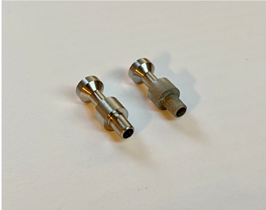
Abbildung 15: Titanbasen links unbehandelt, rechts nach Bestrahlung
