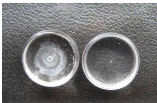
**Abb. 2.4.3-12:** Zerstörte Fenster bei Verwendung eines Hydrofluoroethers HFE-7500 (links) und Dichlormethan  $\text{CH}_2\text{Cl}_2$  (rechts).
