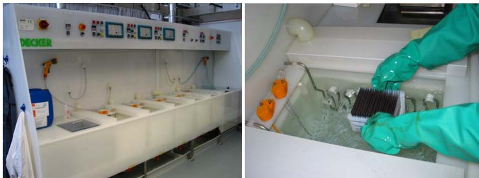
**Abb. 3.1.2-1:** Bei der Slurry-Reinigung eingesetzte Batch-Reinigungsanlage am Fraunhofer Institut für Solare Energiesysteme. Links: Reinigungsbank; rechts: Beladener Wafer-Carrier beim Beckenwechsel.
