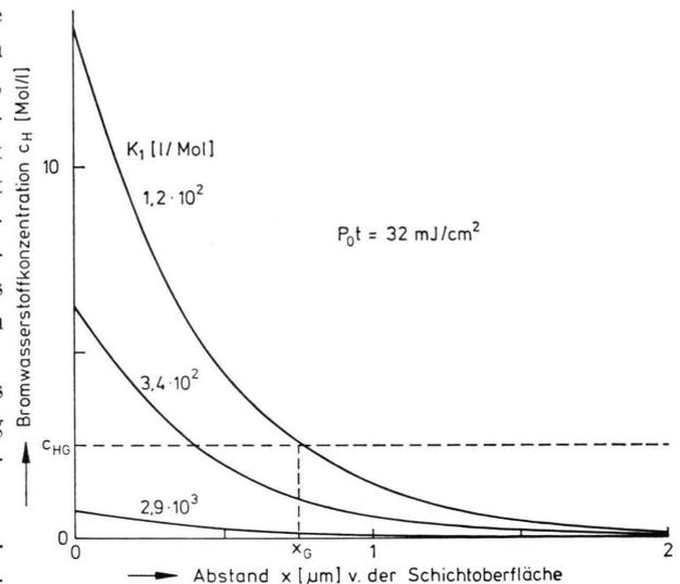
Abb. 3. Profil der Bromwasserstoffkonzentration  $c_H$  in Schichten mit verschiedenen Spiropyranen bei fester Energiedichte  $P_0 t$ .
