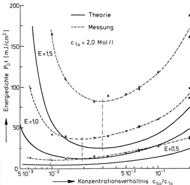
Abb. 1. Zur Verfärbung  $E$  benötigte Energiedichte  $P_0 t$  in Abhängigkeit von der Schichtzusammensetzung  $c_{S0}/c_{T0}$  (Rechnung mit Ansatz ohne Konkurrenzreaktion).
