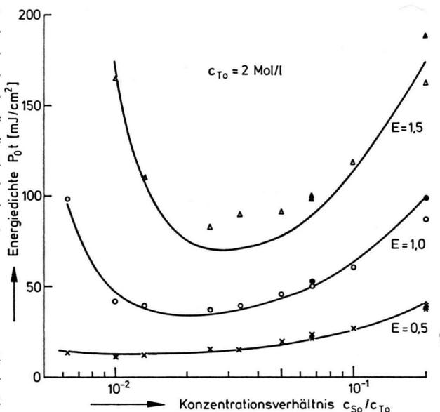
Abb. 2. Vergleich von Rechnung (durchgezogene Kurven) und Messung (xo) für die zur Verfärbung (Extinktion)  $E$  notwendige Energiedichte  $P_0 t$  in Abhängigkeit von der Schichtzusammensetzung  $c_{S_0}/c_{T_0}$ .
