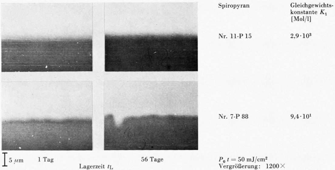
Abb. 6. Verfärbungskanten bei Schichten mit verschiedenen Spiropyranen in Abhängigkeit von der Lagerung (Schichtzusammensetzung 1 — Plexiglas).
