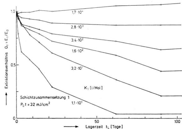
Abb. 4. Extinktionsverhältnis  $Q_t$  als Maß für die Stabilität von verschiedenen Spiropyranen gekennzeichnet durch die Gleichgewichtskonstante  $K_1$  in Abhängigkeit von der Lagerzeit  $t_L$ .
