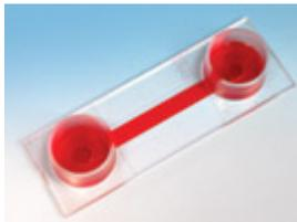
**Abbildung 6: Flusskammersystem IBIDI**
