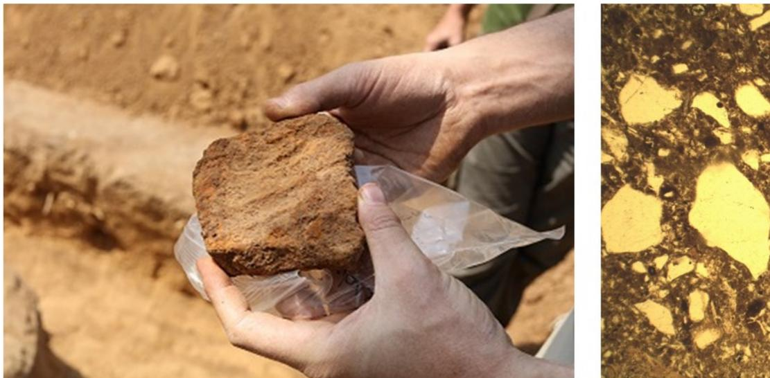
*Abbildung 5.1: Auf der linken Seite: Ofenwand mit Fingerabdrücken, die auf eine Geste während des Baus des Ofens hinweisen. Rechts: Petrographisches Bild eines Ofenwandstücks, das die Materialeigenschaften zeigt (Foto links: Peter Breunig, Foto rechts: Quinn 2016: 11, Abb. 2).*
