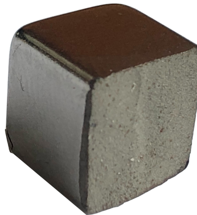
Abb. 6.1: Gebrochener Magnet durch unsachgemäße Handhabung.
