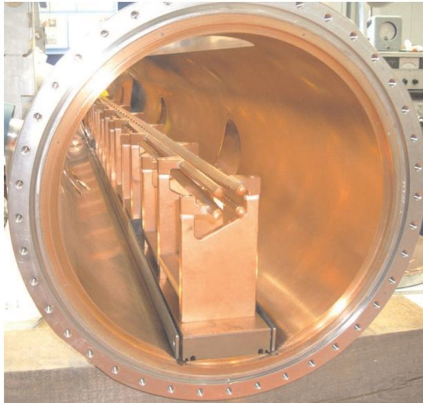
Abbildung 2.9: HITRAP-RFQ. An den Stützen sind die vier sinusmodulierten Stäbe fixiert, die das Quadrupolfeld erzeugen.
