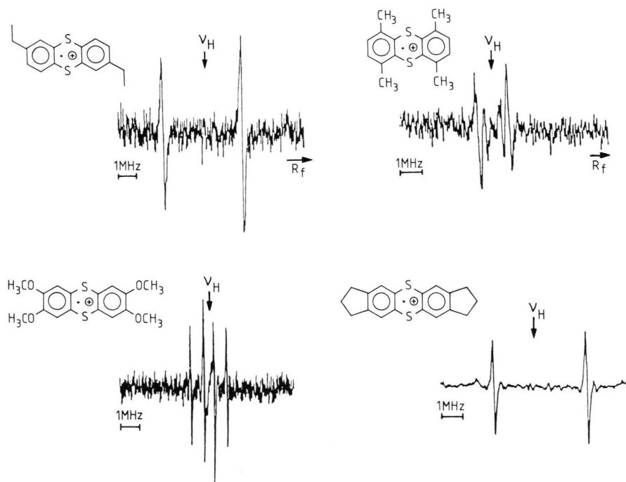
Abb. 4. ENDOR-Spektren der durch \text{AlCl}_3/\text{H}_2\text{CCl}_2 -Oxidation (7: A und B) erzeugten 2,7-Diethylthianthren-, 1,4,6,9-Tetramethylthianthren-, 2/3,7/8-Bis(trimethylen)thianthren- und 2,3,7,8-Tetramethoxythianthren-Radikalkationen bei den in (9) angegebenen Temperaturen.
