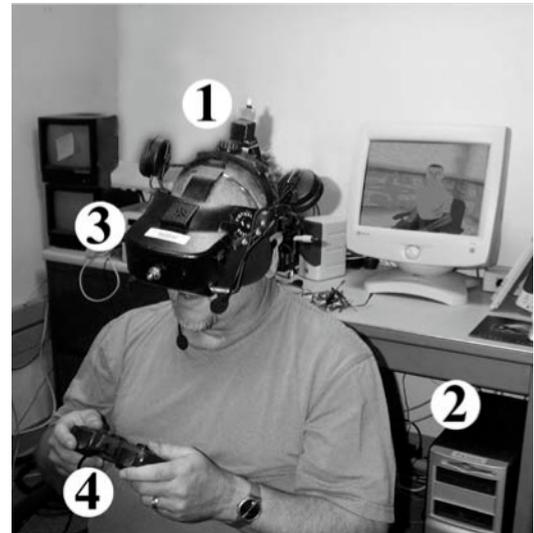
Abbildung 91: Foto des Simulationsaufbaus mittels HMD des VR-Tools von Bailenson et al., Quelle: Bailenson et al. (2008, S.114)
