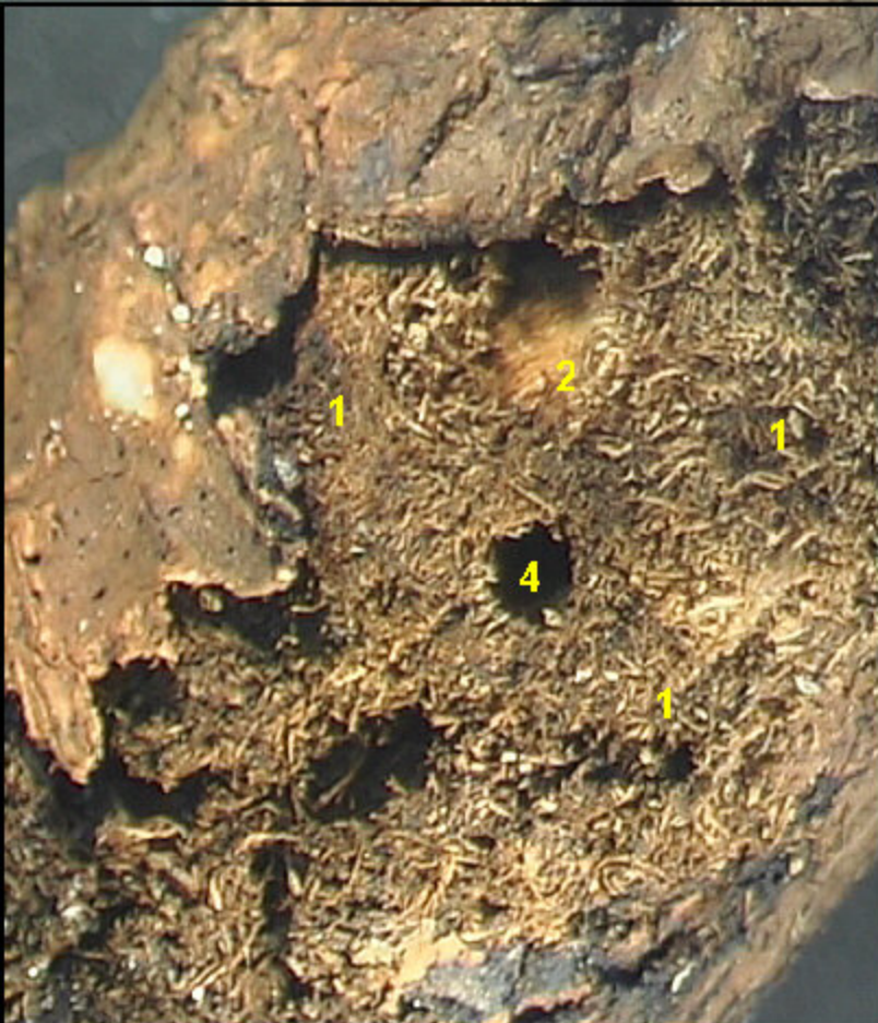
1. Flächenhafter Raspelspäne-Bereich der ersten beiden Larvalstadien, 2. Schräg verlaufender Larvenkanal in den harten Splintholzbereich, 3. Larve im Splintholz unmittelbar vor der Verpuppung, 4. Schlupfloch der Imago.
