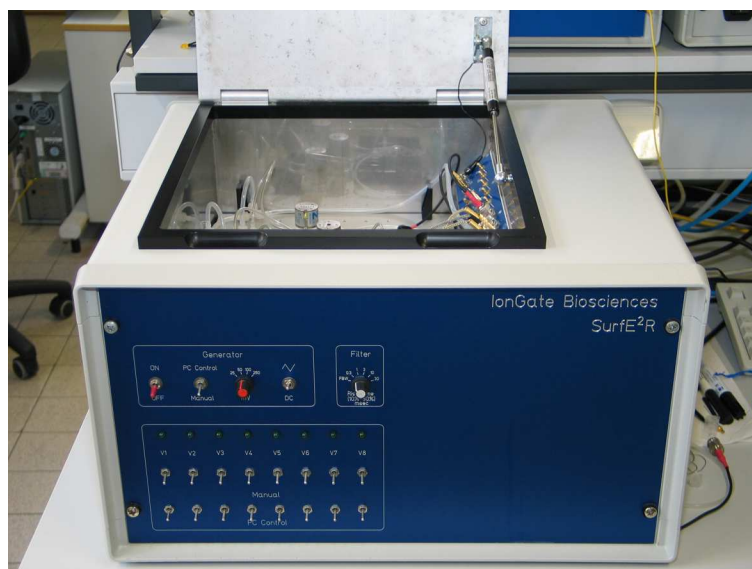
Abbildung 2.8: SURFE 2 R-Messsystem. Die gezeigte Version, die in dieser Arbeit benutzt wurde, war ein Experimentiergerät, das für die Prototypen-Entwicklung verwendet wurde.
