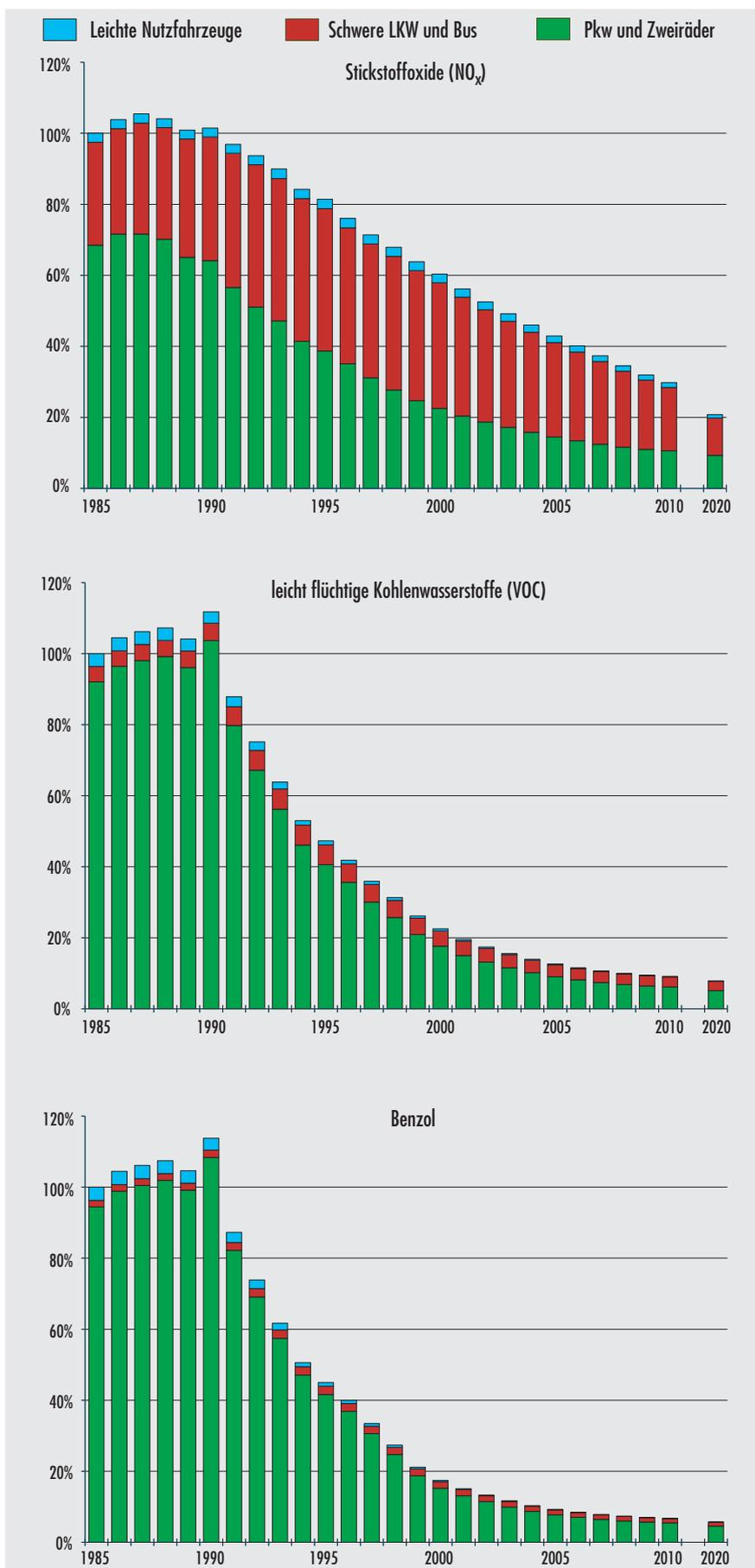
Abb. 15 Prognostizierte Entwicklung der Kfz-Emissionen in Deutschland 1985-2010. Werte berechnet mit dem Verkehrsemissionsmodell TREMOD unter Berücksichtigung der Euro 4-Grenzwerte. Angabe in Prozent, bezogen auf 1985 (Quelle: IFEU Heidelberg; Stand 1999)
