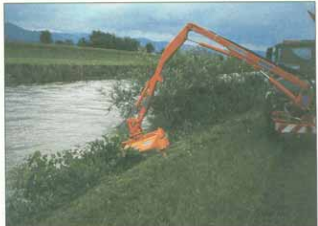
Auslegermähwerk bei der Neophytenmähd im Uferbereich (Aufn.: Gewässerdirektion Rhein, Bereich Offenburg)
