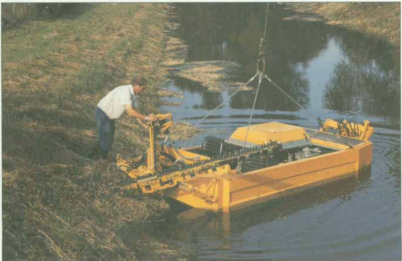
Wassergestützte Krautung – Mähboot beim Wassern (Aufn.: Gewässerdirektion Rhein, Bereich Offenburg)
