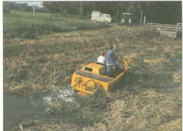
Wassergestützte Krautung – Mähboot im Einsatz (Aufn.: Gewässerdirektion Rhein, Bereich Offenburg)
