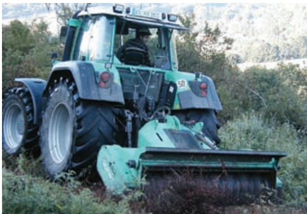
Je nach Topographie und Wertigkeit des Bewuchses erfolgt die Sommernachpflege mit unterschiedlichen Mitteln. Im Bild erreicht ein Forstmulcher in einem fünfständigen Einmaleinsatz die gleiche Nachhaltigkeit (= Unterdrücken der Stockausschläge auf fast Null), die sonst einen ca. einwöchigen „Handarbeitseinsatz“ (Freischneider, Abtragen etc.) über mehrere Jahre hinweg erfordert hätte.
