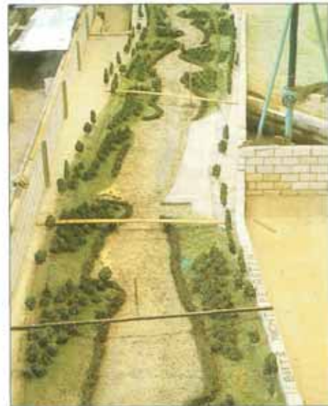
Bild 3: Entwicklungszustand. Ausgangsvariante (Bordvoller Abfluß bereits bei 350 \text{ m}^3/\text{s} ). Enz-Modell
