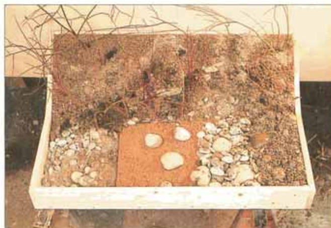
Darstellung der aufeinanderfolgenden Phasen der Sohlensicherung mit drei Kornfraktionen (Modell): Nach erfolgter Sohlenvertiefung beginnt der Einbau des Filters. Nun folgt das Versetzen der Stützblöcke. Danach wird die Geröllfüllung eingebracht und das Feinsediment unregelmäßig über die Sohle verteilt.
