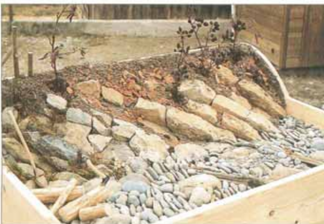
Fertige Felsbanksicherung (Modell) mit dem durch roten Ziegelschrot dargestellten Übergangsbereich und den in vorbereitete Pflanzlöcher versetzten Ufergehölzen. Fließrichtung von rechts nach links.
