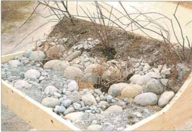
Fertig ausgeführte Sohlensicherung mit drei Kornfraktionen (Modell). Das Feinsediment ist noch nicht eingeschwemmt.
