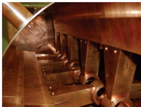
Abbildung 7.35: Induktiver Einkoppler in der Mitte des Kupfermodells der CH-Struktur
