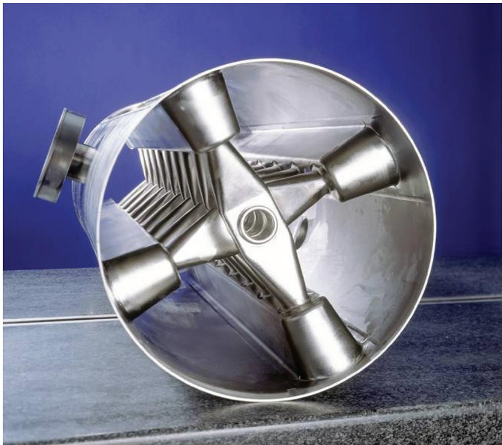
*Abbildung A.4: Komplette CH-Struktur vor Anbringung der Enddeckel*
