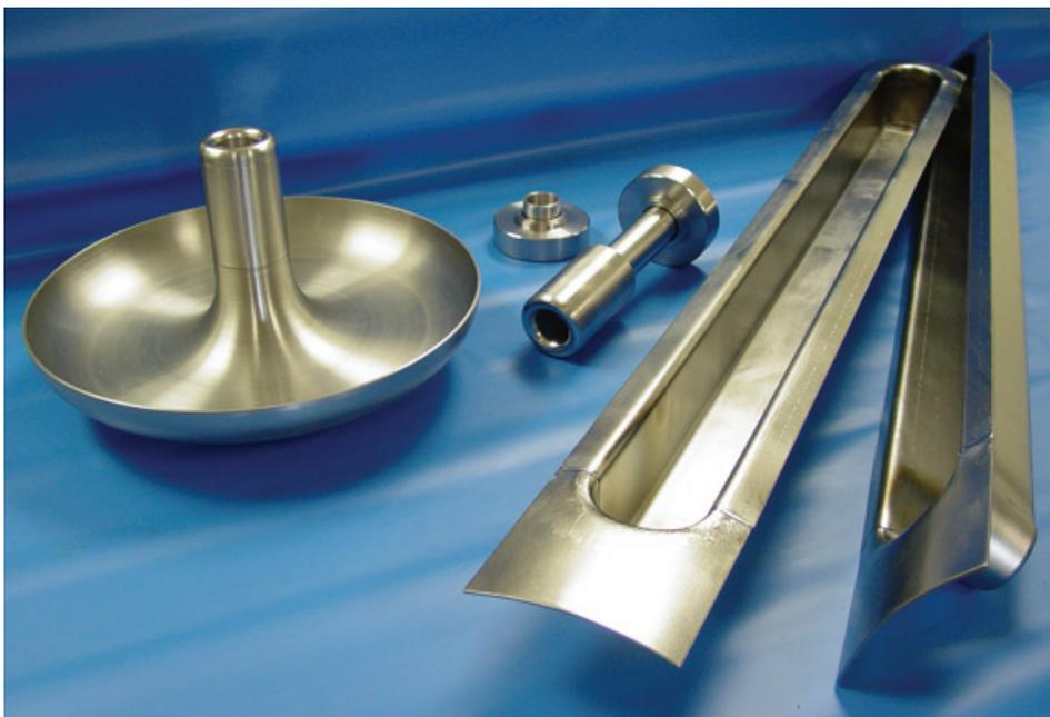
*Abbildung A.2: Zwei Rippen (rechts), ein Enddeckel (links) und eine Enddriftröhre (Mitte) des Prototyps*
