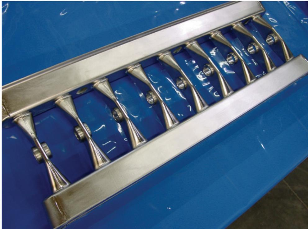
*Abbildung A.3: Eine fertig verschweißte Ebene der CH-Struktur*
