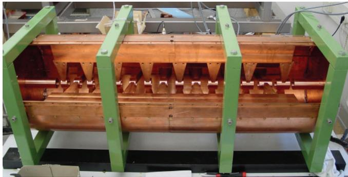
Abbildung 7.34: Kupfermodell einer CH-Struktur
