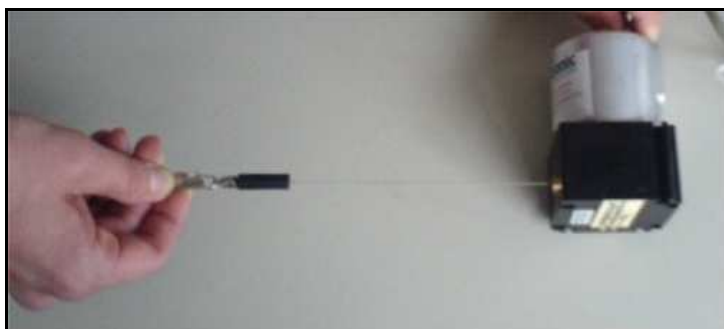
Abbildung 20 – Seilzug-Wegsensor (WDS-1500-P60-CA-E-MT) der Firma Micro-Epsilon, der in der Untersuchung zur Messung der Positionsveränderungen des Probanden auf dem Laufband verwendet wurde.
