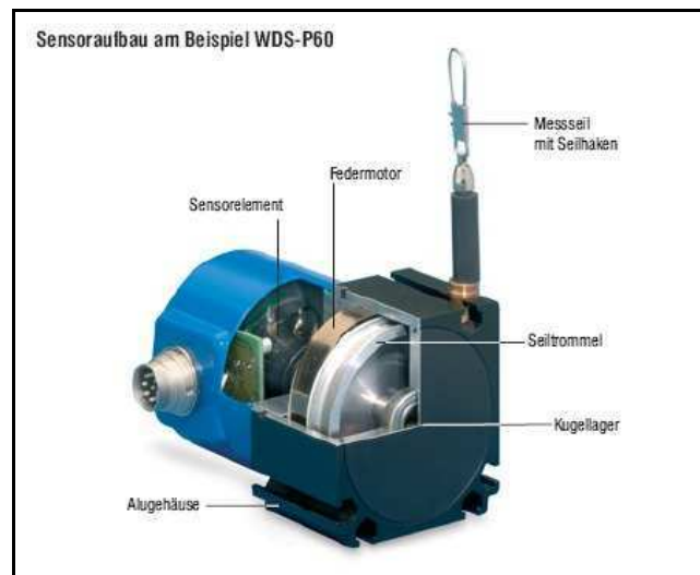
Abbildung 19 – Aufbau eines Seilzug-Wegsensors der Firma Micro-Epsilon am Beispiel WDS-P60 (MICRO-EPSILON DEUTSCHLAND o.J., 2).
