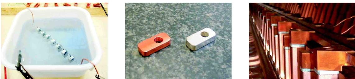
Bild 7.75: Versilberung der Distanzplättchen in Elektrolyselösung (links), das Ergebnis der Versilberung (Mitte) und die eingebauten Plättchen (rechts).
