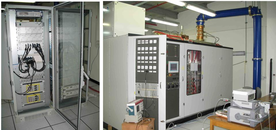
Bild 7.77: Links: Geräte zur erzeugung der LLRF (*low level radio frequency*) und rechts der Leistungsverstärker THA-300 für den SARAF-RFQ. Im Bild rechts ist die Koaxialleitung der Leistungsübertragung zum RFQ sichtbar.
