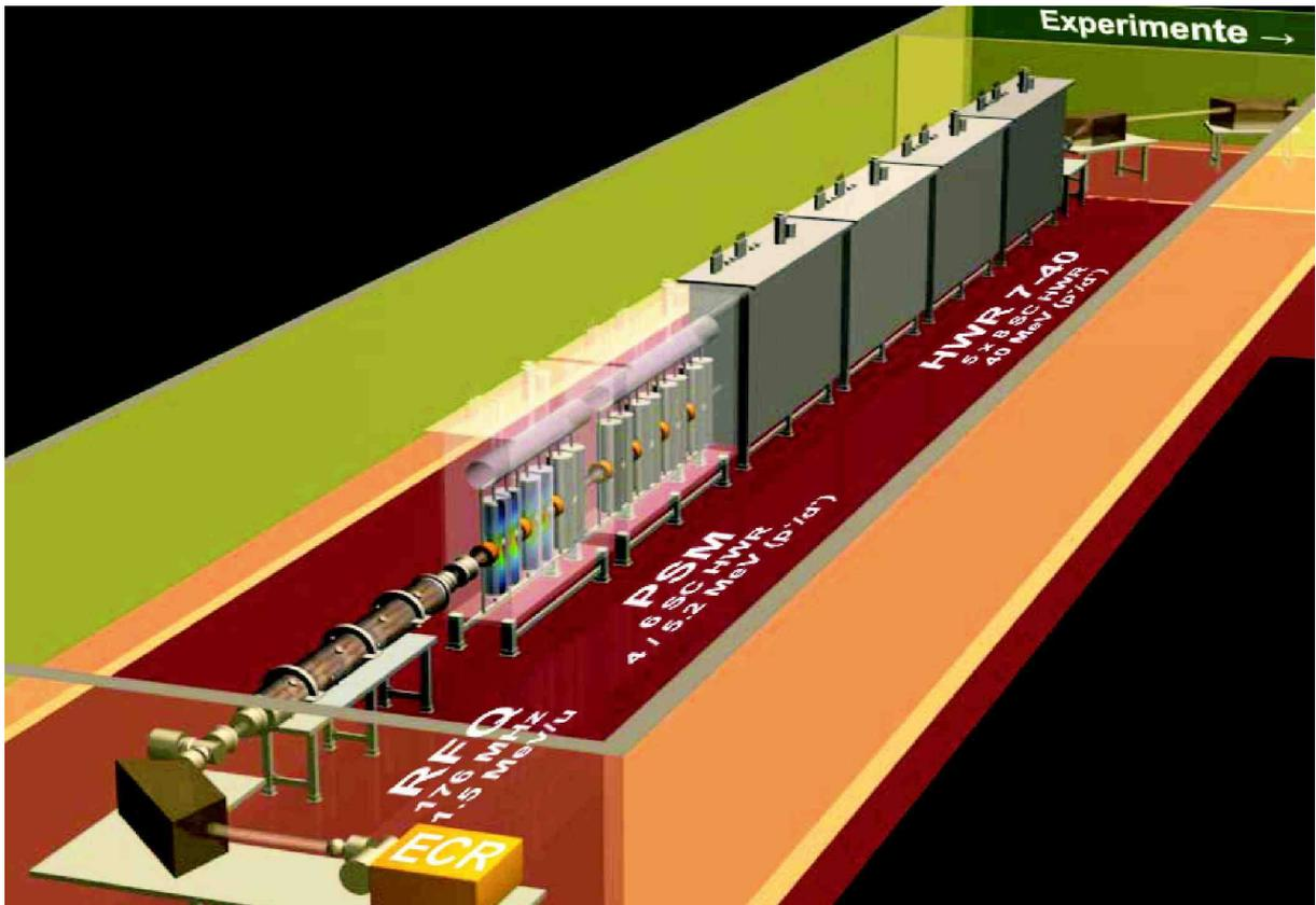
Bild 2.6: Räumliche Ansicht des Gebäudetrakts für die Beschleunigeranlage mit EZR-Ionenquelle, Radio Frequenz Quadrupol, PSM (prototype superconducting module) und HWR (half wave resonator). Zur Größeneinordnung: der RFQ hat eine Länge von 3.8 m.
