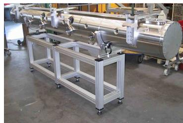
Bild 7.65: Der SARAF RFQ Tank (NTG *Neue Technologien*, Gelnhausen).
