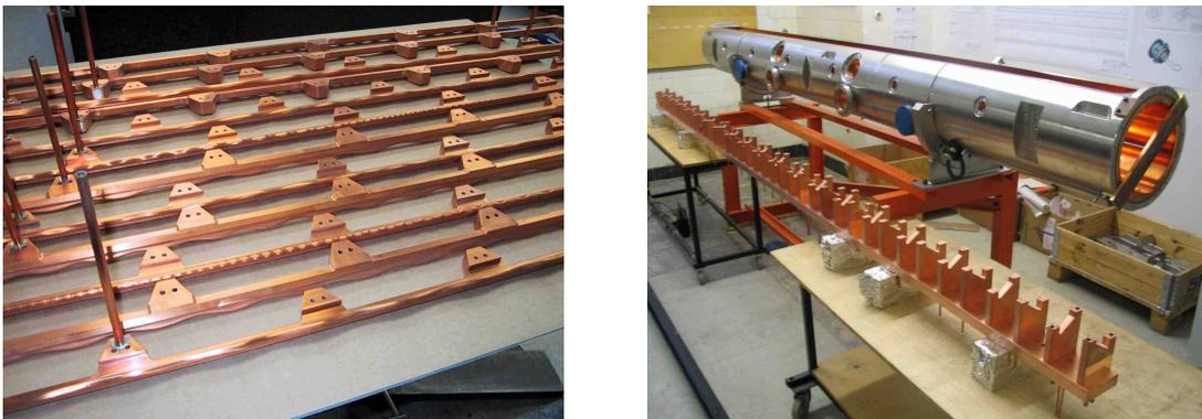
Bild 7.69: Elektroden nach der Lötung, unverkupfert (links), und die Bodenplatten mit Stützen neben dem Tank (rechts).
