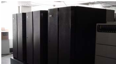
Abb. 1: von links nach rechts: Frame ausgestattet mit 8 Doppelprozessorsystemen (Winterhawk), Mitte – Testframe, rechts Frame ausgestattet mit drei 16 Prozessor Nighthawk SMP-Knoten
