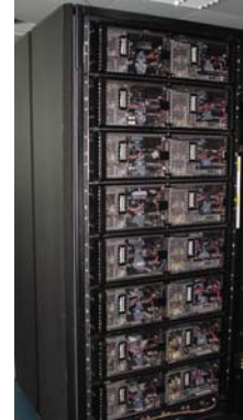
Abb.2: IBM SP2 Frame ausgestattet mit 8 Doppel- prozessorsystemen Typ „Winterhawk“
