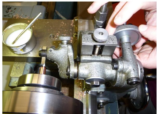
Frau J. Giesecke beim Kugeldrehen mit dem Kugelapparat
