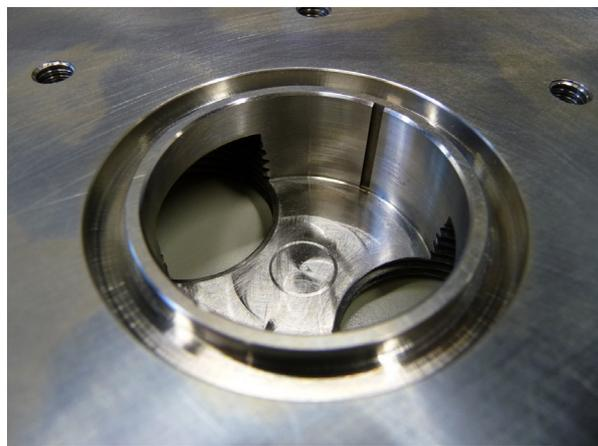
Teilbearbeitung durch Funkerosion
