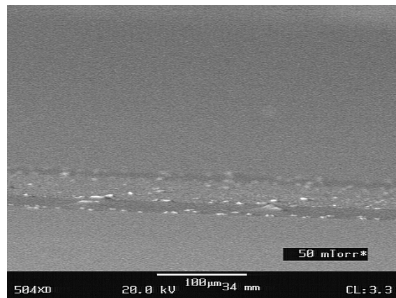
Trocknungsrückstand auf siliconisierten (hydrophoben) Quarzprobenträger
