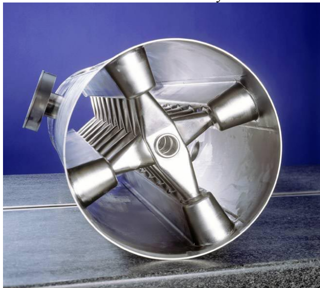
Abbildung 4: Supraleitende CH-Struktur kurz vor der Fertigstellung
