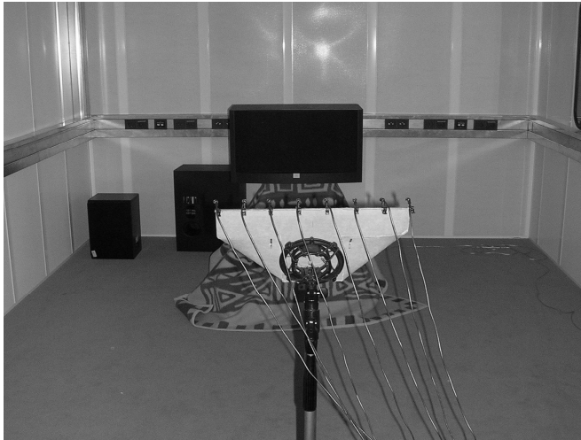
Bild 20: Messaufbau zur Untersuchung von Mikrofonarrays.
