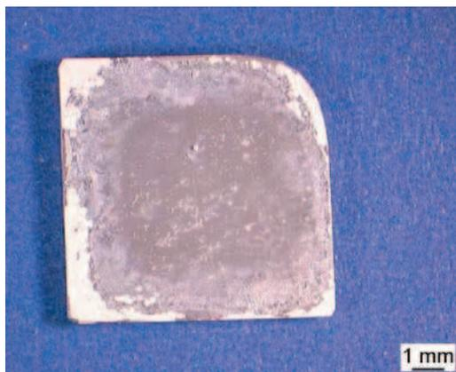
Abb.3.: Stereomikroskopische Aufnahme einer mit 0.113 m.-HF-Lösung behandelten TiAl-Probe nach Oxidation (12h/900°C/Luft). Eine dünne  $Al_2O_3$ -Schicht bedeckt die Oberfläche, während das helle  $TiO_2$  von den unbehandelten Kanten stammt.
