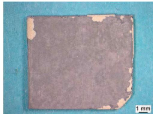
Abb. 1: Stereomikroskopische Aufnahme einer mit Fluorionen implantierten TiAl-Probe nach Oxidation (120h/900°C/Luft). Auf der Oberfläche wurde eine dünne ( $< 1\mu\text{m}$ ) Al<sub>2</sub>O<sub>3</sub>-Schicht gebildet. Das helle Titanoxid stammt von den nicht implantierten Kanten.
