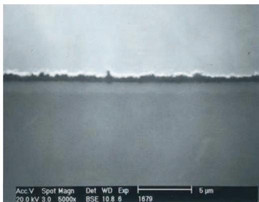
Abb.4: REM-Aufnahme eines Querschliffs der Probe aus Abb. 3. Die dunkle  $Al_2O_3$ -Schicht hat eine Dicke von  $< 1 \mu m$ .
