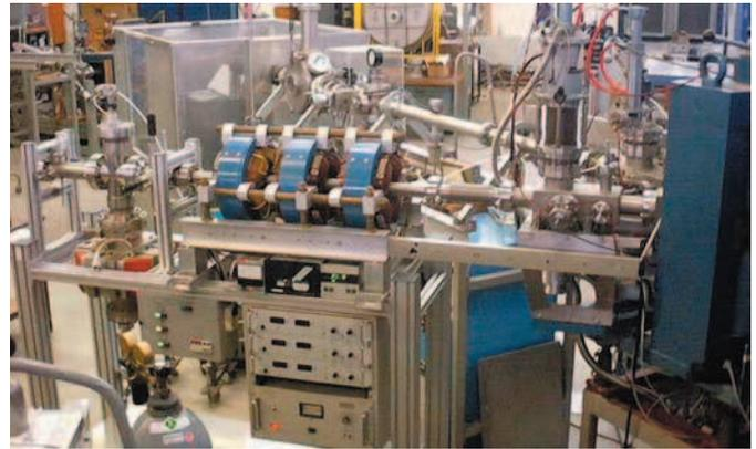
**Abb.3:** 90-Grad-RFQ Strahlrohr (Vordergrund). Zu erkennen sind die beiden Diagnosekammern und das magnetische Quadrupoltripllett als die wesentlichen Komponenten des Aufbaus. (im Hintergrund das 45-Grad-RFQ Strahlrohr mit dem Abbremssterminal).
