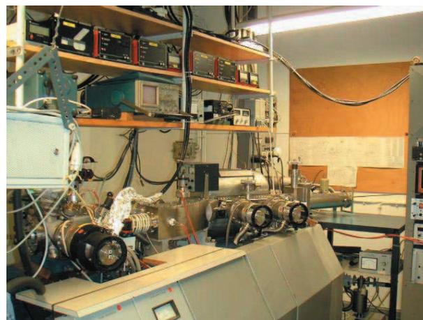
Bild 3: SSMS – Massenspektrometer, Typ 21-110.
