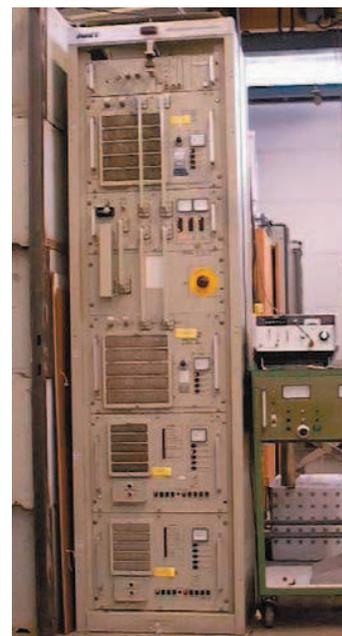
**Abb.2:** Das neue (alte) Mikrowellenverstärkersystem
