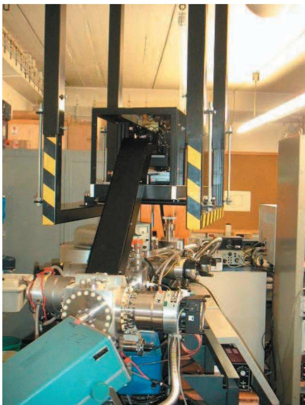
Bild 1: LSMS – das Licht des Nd:YAG-Laser (oben) wird über einen Spiegel mit einem Winkel von  $60^\circ$  relativ zur ionenoptischen Achse des Massenspektrometers (unten) auf die feste Probe gebracht.
