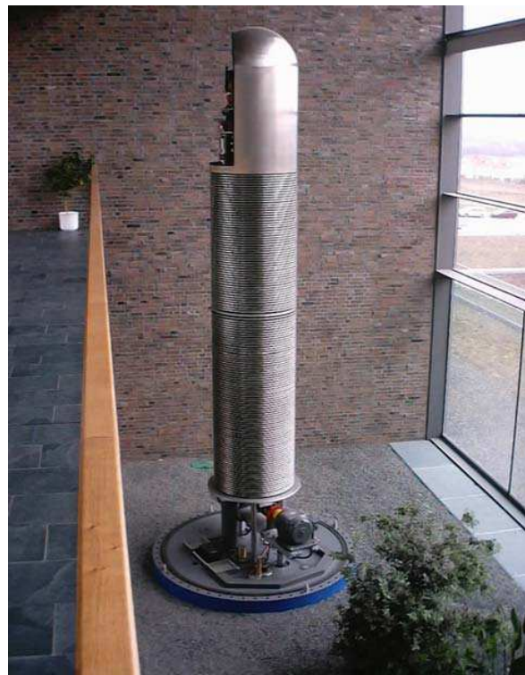
Abbildung 3: Die Struktur des 7.5MV van de Graaff Beschleunigers als Baudenkmal in der Magistrale des neuen Instituts (Vom Drucktank des Systems (2,5m Durchmesser, Innendruck bei Betrieb 16bar) ist nur der Bodenflansch zu sehen).
