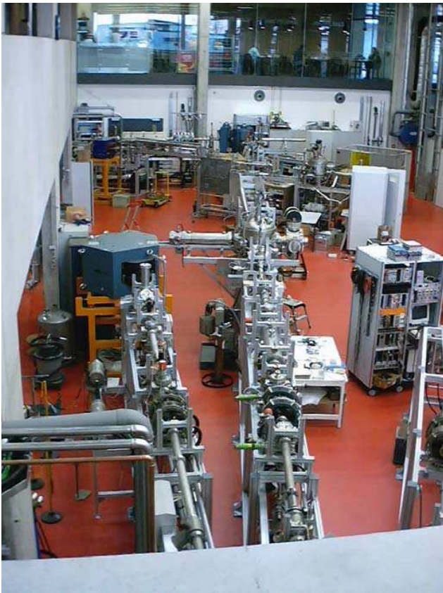
Abbildung 1: Blick in die Experimentierhalle vom Dach des „Beschleuniger Caves“ des 2,5MV van de Graaff Beschleunigers. Im Vordergrund ist die Strahlrohrinfrastruktur des Beschleunigers und ein Schaltmagnet zum Strahltransport in das angrenzende Labor zu sehen. Im Hintergrund ist der Schaltmagnet (ganz links) und die RFQ (teilweise durch den Schaltmagneten verdeckt) sowie Teile der Strahlrohrinfrastruktur der EZR-RFQ Anlage sichtbar.
