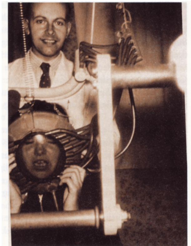
Abbildung 3: Die von uns neu konstruierte Gesichtsmaske für die spiroergometrische Untersuchung
