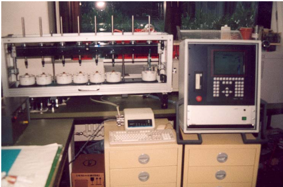
Abb. 10. Der Kausimulator der Fa. WILLYTEC: im Vordergrund rechts die Steuerungseinheit, links daneben die mikroprozessorgesteuerte Pumpe für das Rücklaufsystem der „slurries“. Im Hintergrund links der eigentliche Simulator.
