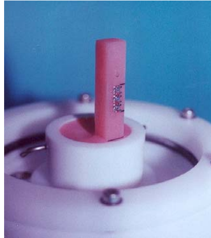
Abb. 11 und 12. Probenr ager f ur B ander (links) und Brackets (rechts). Um Kontakt zu Fremdmetallen zu verhindern, wurden die Probenr ager aus Teflon bzw. PMMA gefertigt. Der Haltedorn am Probenr ager wurde zudem mit Silikonschlauch ummantelt (Pfeil).
