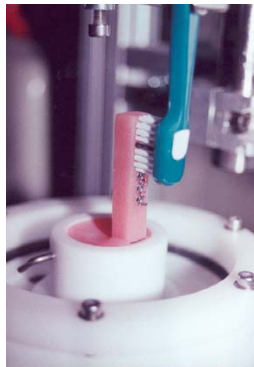
Abb. 13 und 14. Die Probenr ager sind im Simulator fixiert. Es erfolgt nun die Einstellung von Anpresskraft und Hubh ohe der Zahnb urste.
