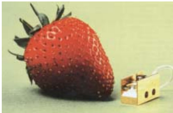
Infrarot-Halbleiter im Größenvergleich: Mit diesen Lasern, die Bleiverbindungen als aktives Medium nutzen, kann Infrarotstrahlung bei verschiedenen Wellenlängen erzeugt werden.
