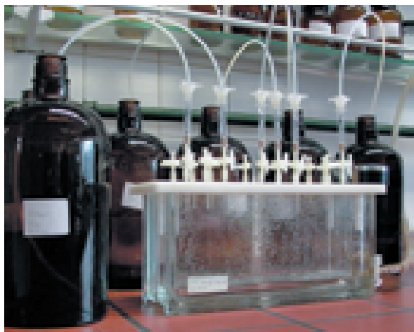
Apparatur zur Festphasenextraktion am Institut für Mineralogie der Universität Frankfurt. Hier werden Wasserproben auf organisch-chemische Verunreinigungen untersucht.
