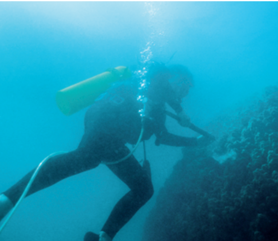
10 Eberhard Gischler bei der Entnahme eines Bohrkerns aus einer Steinkoralle vor der Küste von Kuwait, nördlicher Persischer Golf, mit Hilfe eines pneumatischen Bohrers, der von Pressluft aus einer Tauchflasche angetrieben wird.
