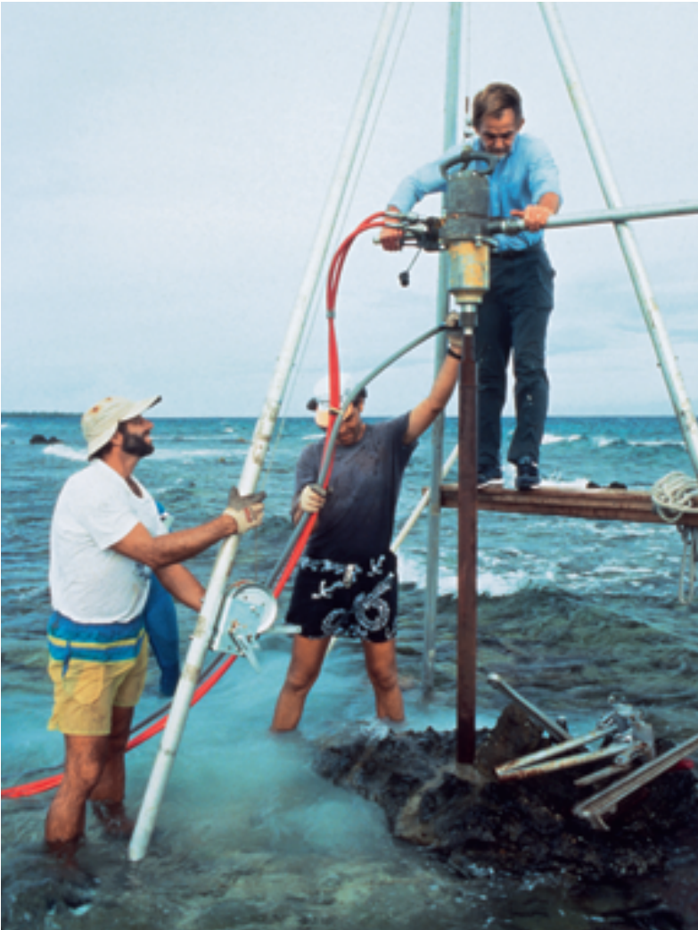
8 Autor mit amerikanischen Kollegen beim Riffbohren mit Hilfe eines tragbaren pneumatischen Bohrers in Belize, Zentralamerika.
