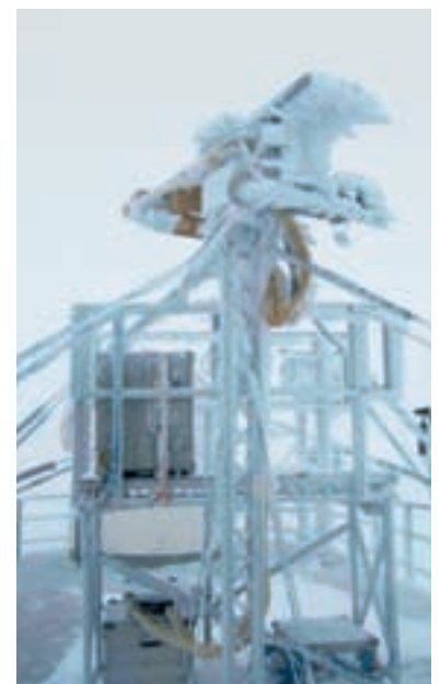
7 Eine Probenahme von Eispartikeln in den Wolken auf der Forschungsstation Jungfrauoch ist eine frostige Angelegenheit. Sie geschieht glücklicherweise im Regelfall automatisch.
