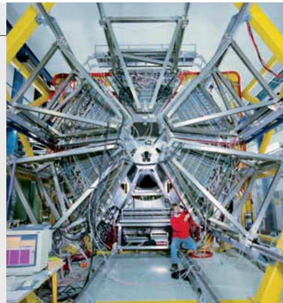
Das HADES-Spektrometer, das heute schon beim GSI Helmholtzzentrum für Schwerionenforschung dem Geheimnis dichter Kernmaterie auf der Spur ist, wird für das FAIR-Experiment aufgerüstet.
