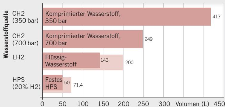
Vergleichender Volumenbedarf zur Speicherung von 10 Kilogramm Wasserstoff. Die erweiterten Volumina für Flüssigwasserstoff (LH<sub>2</sub>) und HPS resultieren systembedingt. Beispiele für systembedingte Größen sind das »Über-Kopf-Volumen«, die Isolation für LH<sub>2</sub> und Packungsdichten für unterschiedliche HPS-Materialien (Pellets, Kugeln, Würfel und so weiter).
