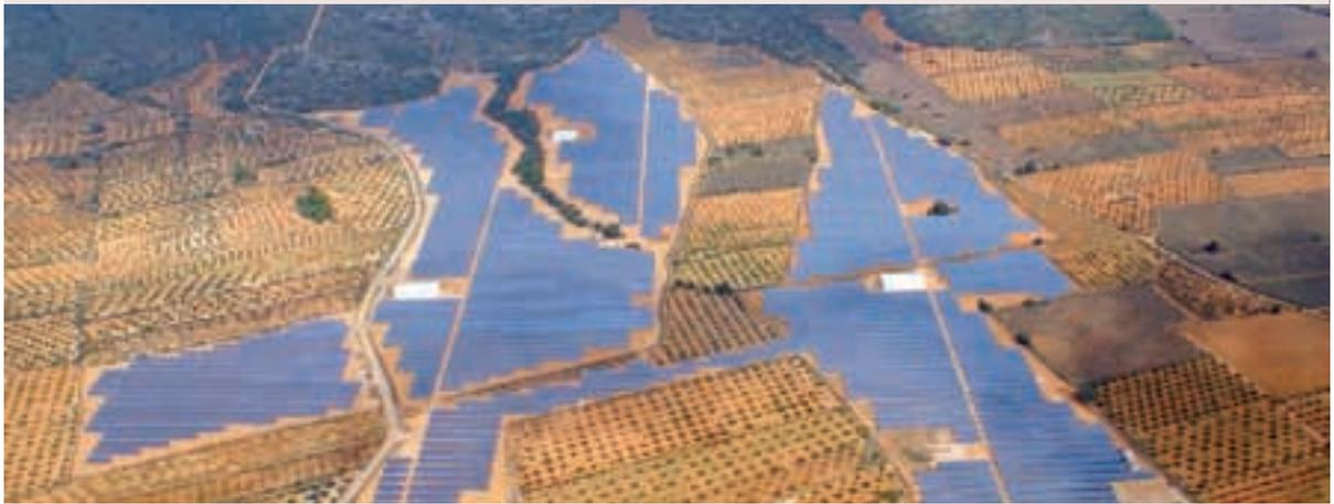
Das weltgrößte Silicium-basierte Photovoltaikkraftwerk mit einer Spitzenleistung von 20 MWp steht derzeit in Benexima, Spanien. Auf einer Fläche von mehr als 500 000 Quadratmetern (circa 71 Fußballfelder), erzeugen circa 100 000 Module den Strom für mehr als 12 000 Haushalte (etwa 3 Millionen Liter Diesel-Äquivalente/Jahr). Die derart erzeugte elektrische Leistung von mehr als 30 Millionen kWh/Jahr führen zu einer CO<sub>2</sub>-Einsparung von mehr als 30 000 Tonnen/Jahr.
