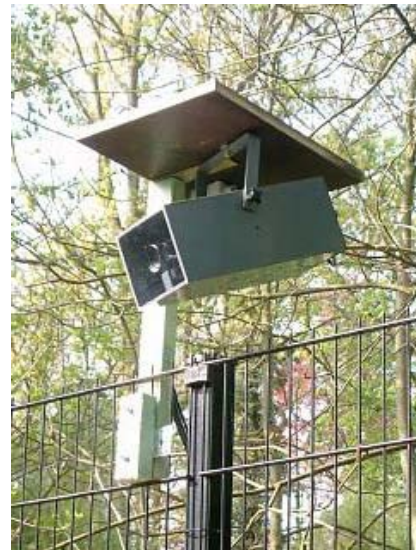
B Videokamera am Außengehege mit Aufhängung und Spritzwasserschutz (Planckendael)
