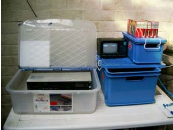
Abb. 20 Aufzeichnungseinheit (Planckendael) bestehend aus Zeitraffervideorekorder, Quadrantenteiler, Netzgeräten und Überwachungsmonitor (teilweise in den Kisten)
