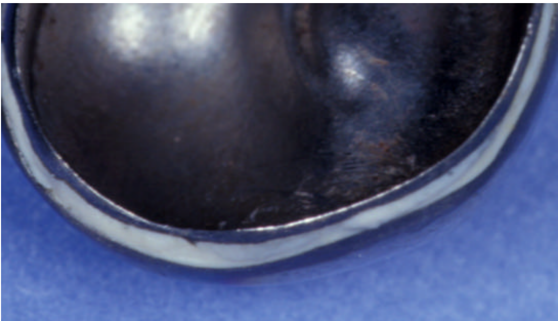
Abb. 19: 25fache Vergrößerung einer freiliegenden Klebestelle (M-Design) von basal
