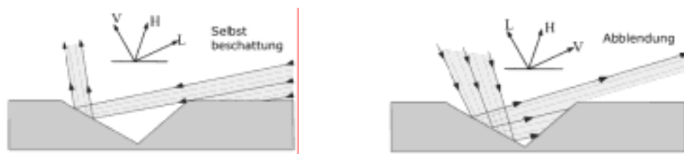
Abbildung 3.8: Links: die Selbstbeschlattung Rechts: die Ablendung [Nayar89]
