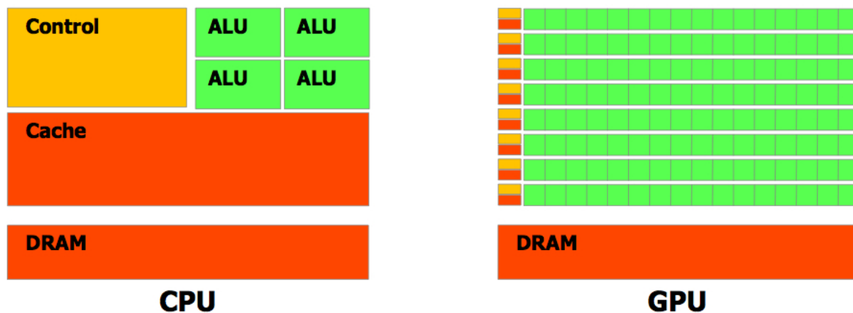
Abbildung 3.3: Schematische Darstellung des prinzipiellen Unterschiedes zwischen CPU und GPU. Quelle: [78]
