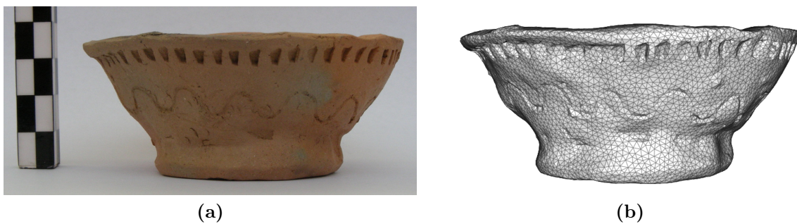
Abbildung 11.6: Modernes Testgefäß zur Bestimmung des relativen Fehlers in der Volumenbestimmung. (a) Handgetöpferte Schale. (b) Rekonstruktion.
