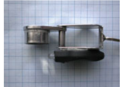
Selbstgebaute Leuchtlupe mit Leuchtdiodenlampe
