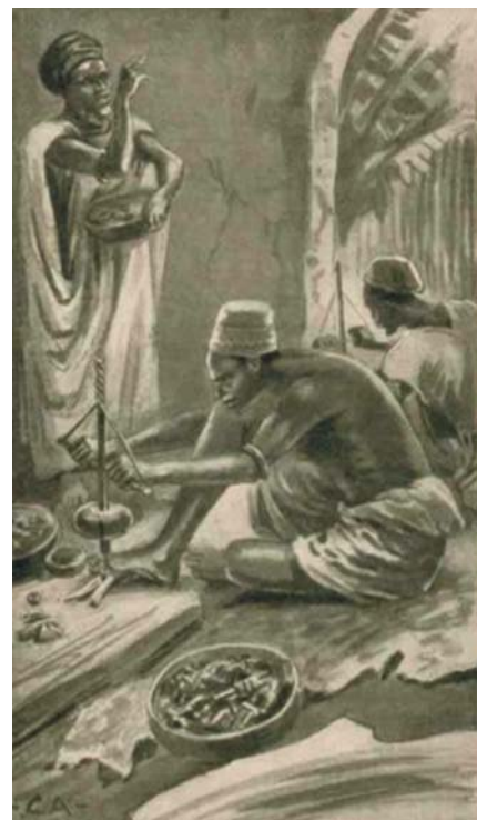
Abb. 90. Durchbohren von Chalzedonperlen.
