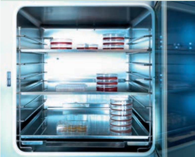
Der Inkubator ahmt die Bedingungen im Körper nach. Hier werden die Zellen bei einer konstanten Temperatur von 37°C und einem CO<sub>2</sub>-Gehalt von fünf Prozent in einem feuchten Millieu gehalten.
