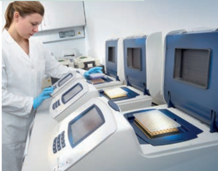
Genkopierer. PCR-Maschinen zur Vervielfältigung von Erbinformationen gehören heute zur Grundausrüstung in molekularbiologischen Labors.
